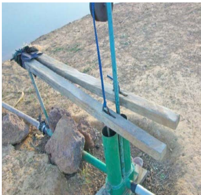
À gauche en haut : pompe à pédales, aspirante refulante simple ;
